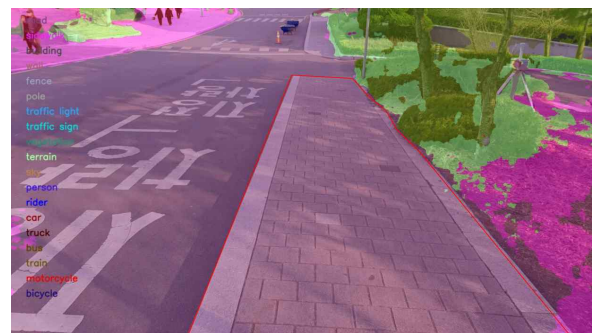
그림 1. DeepLabV3+모델을 CityScapes 데이터셋으로 훈련시킨 결과를 한국 도로 환경에 적용한 결과.
